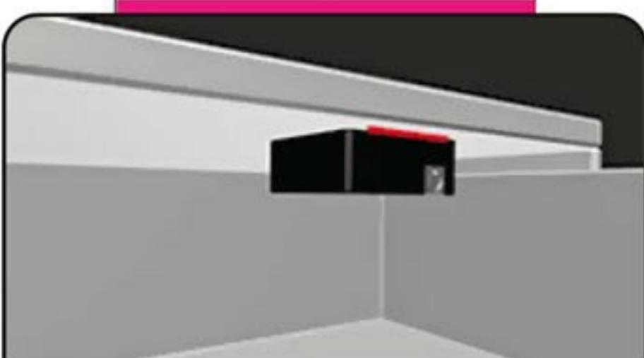
قفل را مطابق شکل زیر کابینت قرار دهید. توصیه می‌شود ابتدا از یک چسب دوطرفه برای قرار دادن موقت آن استفاده کنید تا در صورت بروز هرگونه اشتباه، بتوانید بعداً آن را جایه جا کنید.
