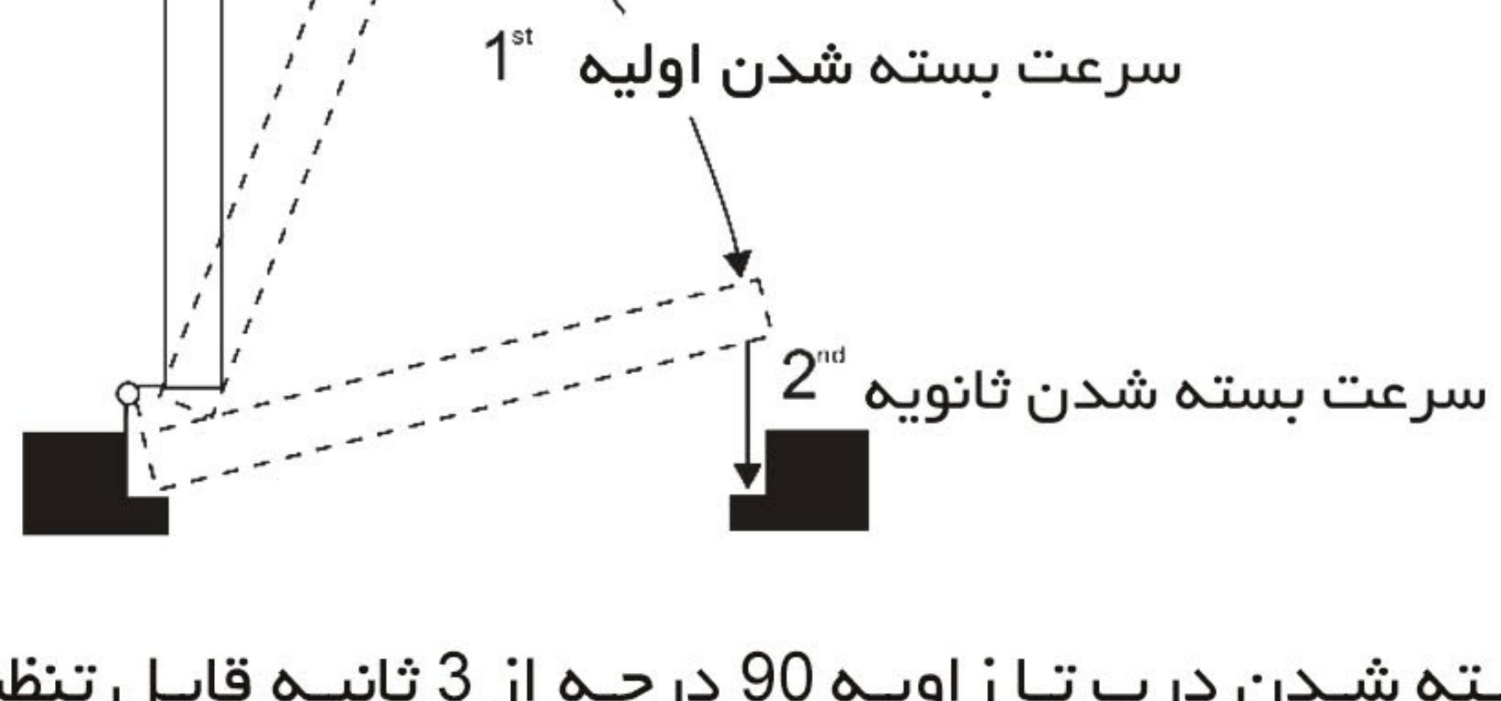
بسته شدن درب تا زاویه 90 درجه از 3 ثانیه قابل تنظیم است و سرعت چفت شدن درب نیز به مدت 60 ثانیه یا بیشتر قابل تنظیم است.
